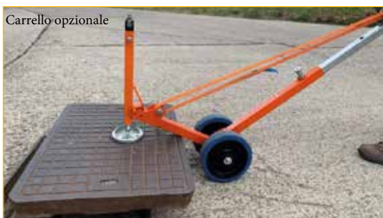
Sollevamento tramite leva carrellata (APS90 o APS80)
